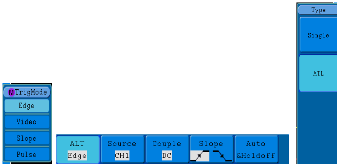
Abb.34 Menü für alternierenden Trigger (ALT) (Triggertyp: Edge)
